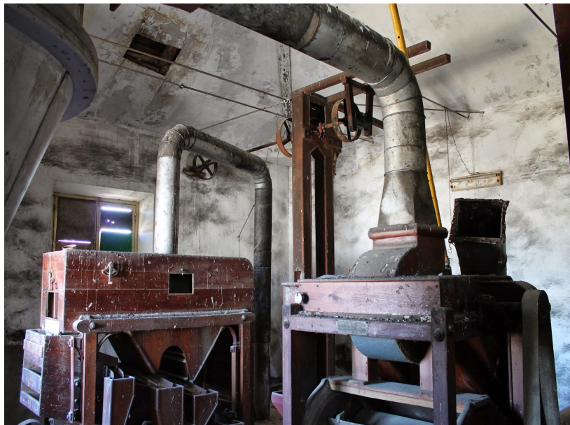
VISTA DE PARTE LA MAQUINARIA DE CERNIDO QUE SE CONSERVA EN LA FÁBRICA
